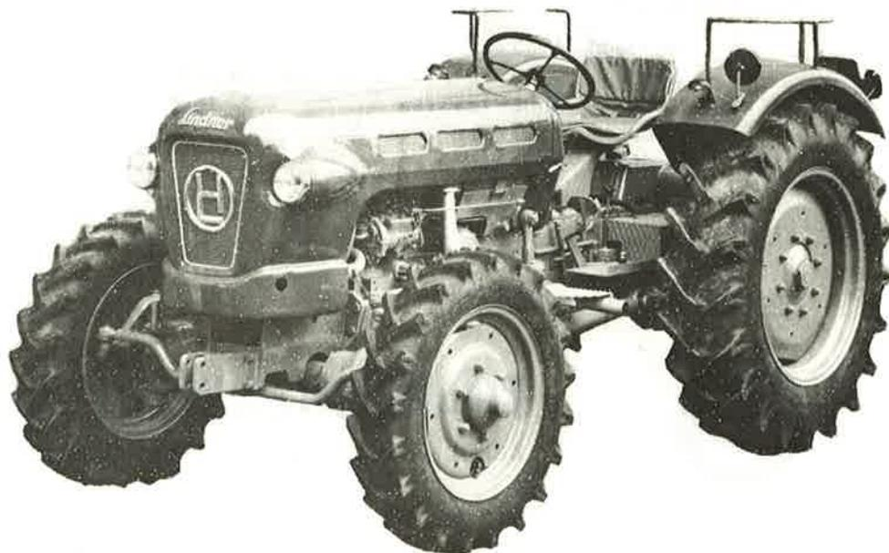
ÄUSSERSTE LAUFruhe DURCH DEN WASSERGEKÜHLTEN 3-ZYLINDER-PERKINS-DIESELMOTOR
